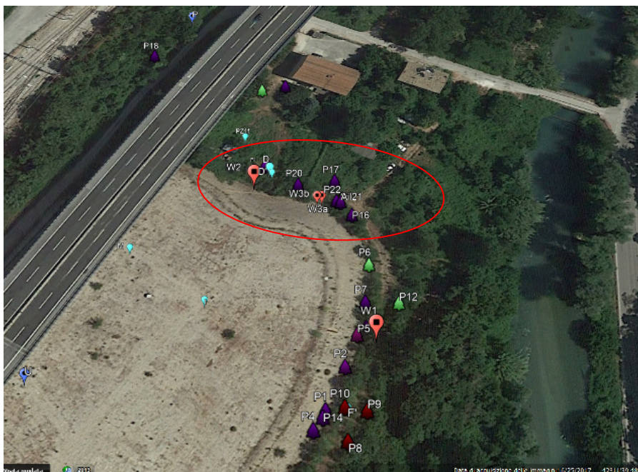
Fig. 1 Ubicazione dei piezometri e degli alberi campionati per indagini di phytoscreening (in viola gli esemplari con concentrazioni significative di solventi in rosso quelli con tracce di solventi)
