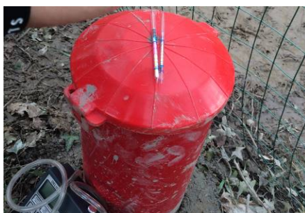
Foto 2 Pozzo W3A e fiale colorimetriche ,in viola la reazione che individua la presenza di solventi clorurati
